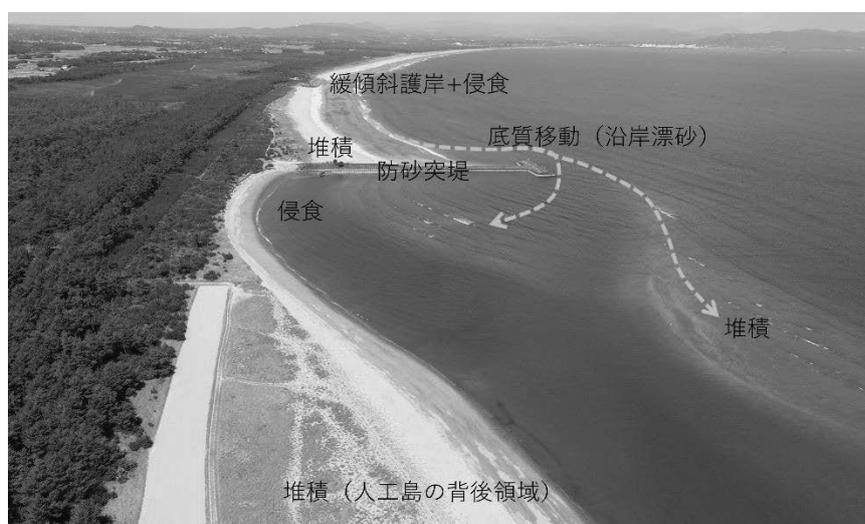
写真－1 人工島築造に伴う隣接海浜の地形変化と底質移動（手前側が人工島背後域）
