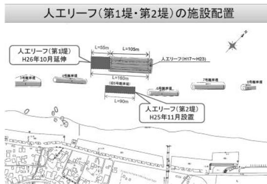
図-10 浜住海岸の人工リーフの配置<sup>13)</sup>
